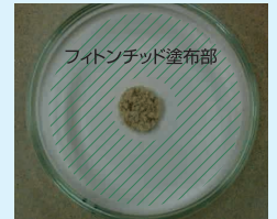
内側シャーレ侵入数 3.7匹 (3回平均) 24時間後 ダニはほとんど侵入なし。
