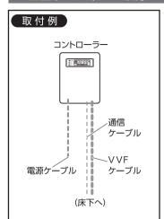
コントローラーは操作しやすい高さ に取付けてください。
