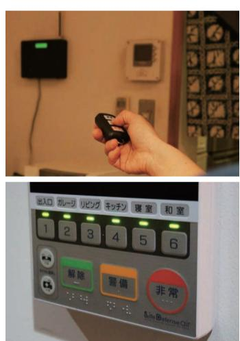
警備および解除はリモコンでもワイヤレスコントローラーからでも出来ます。ワイヤレスコントローラーで警備解除する時には暗証番号の入力が必要となります。
